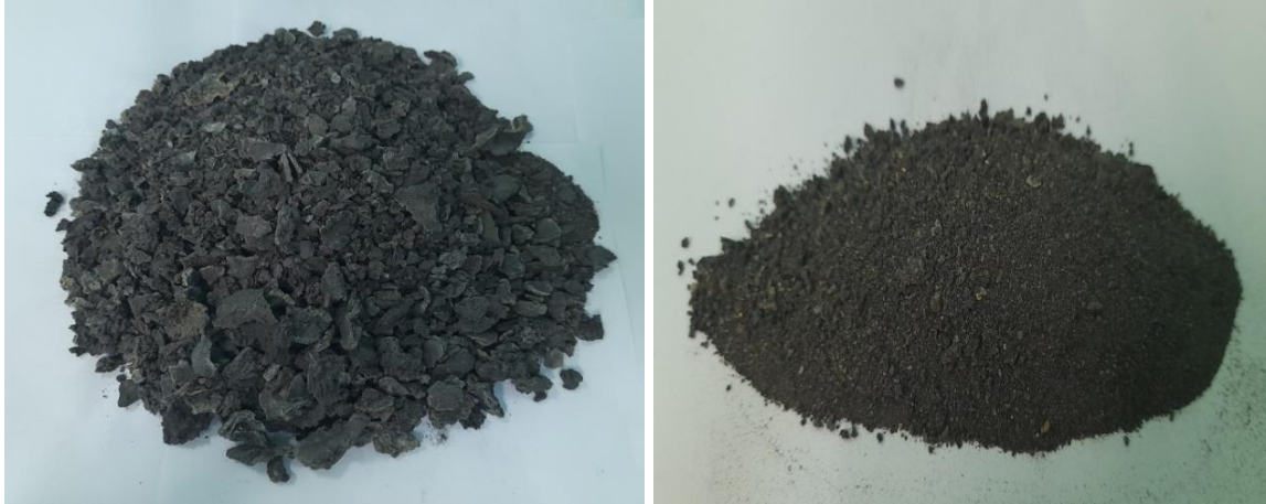
Imagen 2: Escorias y Cenizas de fondo producidas en las Calderas
